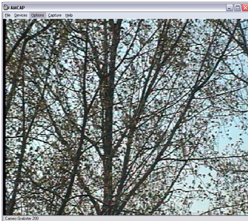
Unter „Options/Video Capture Filter/Image“ können Sie bestimmen, ob das Videosignal über den Composite-In oder S-Video-In eingespeist wird und ob der TV-Standard PAL oder NTSC ist. Unter „Options/Video Capture Pin“ können Sie die Auflösung einstellen.
