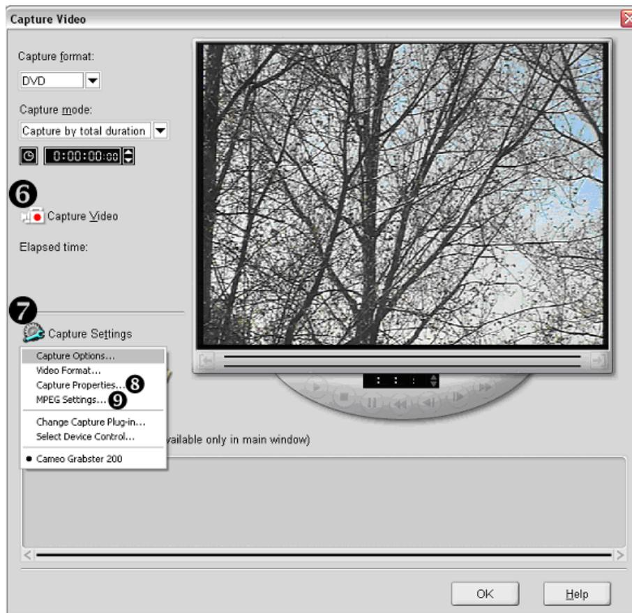
Vous pouvez voir le signal vidéo de votre source analogique dans la fenêtre de prévisualisation. Vous pouvez modifier des paramètres en cliquant sur Capture Settings 7. Sous MPEG Settings 9, vous pouvez sélectionner le taux de bits (qualité vidéo) et le format audio. L'exemple ci-dessous illustre les paramètres pour le format d'enregistrement DVD :
