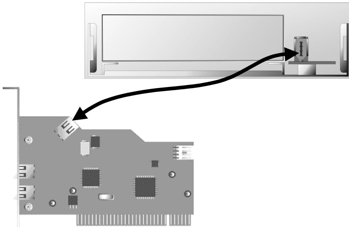
Möchten Sie IEEE 1394-Geräte anschließen, die nicht über eine eigene Spannungsversorgung verfügen, empfiehlt es sich das Cameo Connect Frontmodul direkt über das PC-Netzteil mit Strom zu versorgen. Das verhindert eine Überlastung durch zu hohe Leistungsaufnahme der IEEE1394-Geräte.
