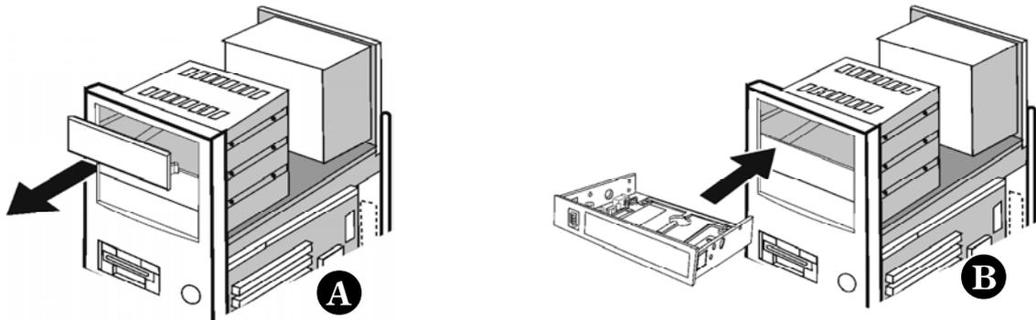
Befestigen Sie das Frontmodul mit den beiliegenden Schrauben am PC-Gehäuse.
