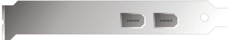
An Ihrem Camcorder finden Sie eine Buchse die mit „DV IN“, „DV IN / OUT“ oder „iLink™“ beschriftet ist. Verbinden Sie den kleineren Stecker des FireWire™-Kabels mit der Buchse Ihres Camcorders und den größeren Stecker mit der Cameo 400 DV.
