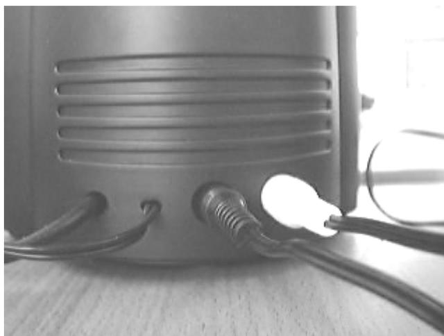
6. A continuación, conectar el adaptador de corriente a una toma normal.
