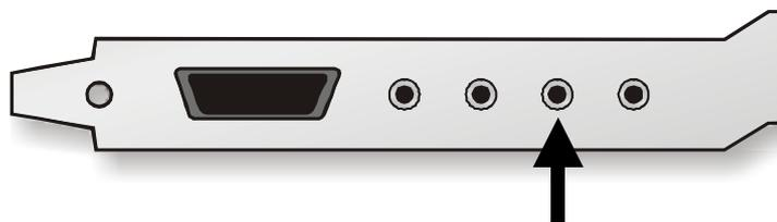
*Salida de audio de la tarjeta TV / Entrada de audio de la tarjeta de sonido*
