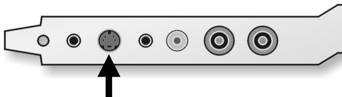
Con este conector puede conectar aparatos con salida SVHS a su tarjeta de TV. Aparatos externos que disponen de salida SVHS se dejan conectar mediante un cable a la tarjeta de TV la cual tiene a ambos lados un conector macho SVHS (vea la ilustración siguiente).
