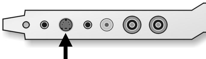
Über diese Buchse können Sie Geräte mit einem SVHS-Ausgang mit der TV-Karte verbinden. Externe Geräte, die über eine SVHS-Out Buchse verfügen, lassen sich über ein Verbindungskabel an die TV-Karte anschließen, welches auf beiden Seiten einen männlichen SVHS-Stecker aufweist. (siehe folgende Abb.)
