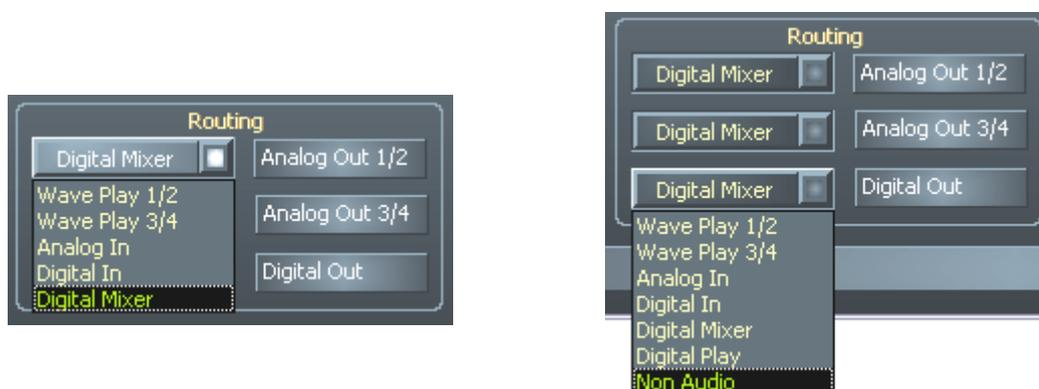
*Le possibilità di routing del PHASE X24 FW*
