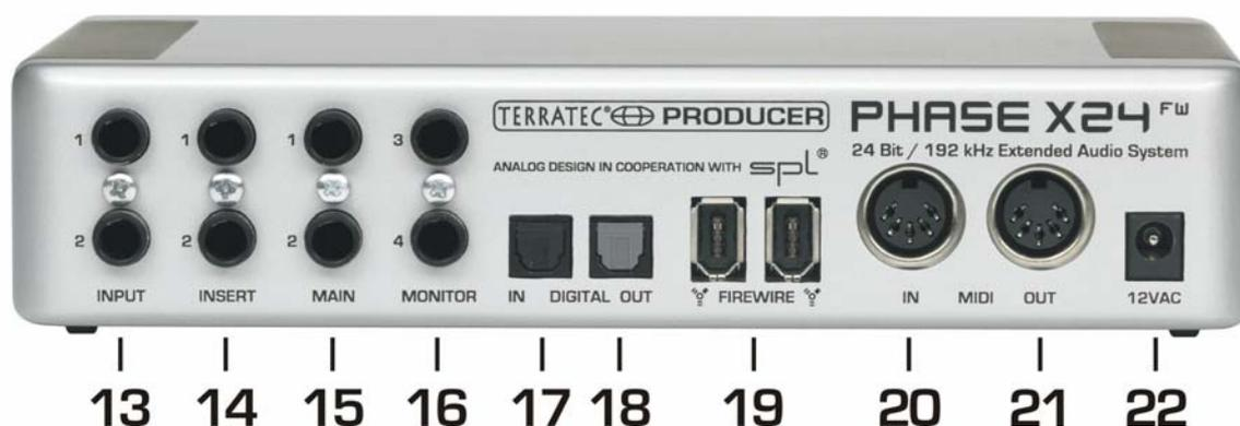
**13. Input 1/2**, il sistema PHASE X24 FW è dotato di due ingressi analogici mono di alta qualità. Queste prese sono realizzate in modo simmetrico con prese jack da 6,3 mm. Possono essere però anche collegate naturalmente sorgenti asimmetriche. Anche qui l'amplificazione dell'ingresso può essere regolata tramite il regolatore Gain sul davanti.
