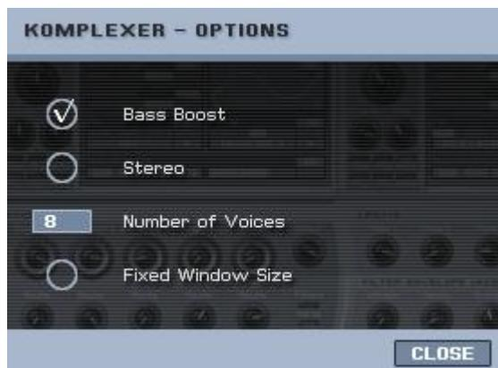
**Fixed Window Size** – la finestra della tastiera del KOMPLEXER VST viene visualizzata con un formato di dimensioni inferiori. Alcuni programmi audio non supportano all'interno di un plugin dimensioni di finestre diverse. Con questa opzione è possibile fissare la dimensione della finestra in modo che il KOMPLEXER VST venga visualizzato sempre in modo completo.
