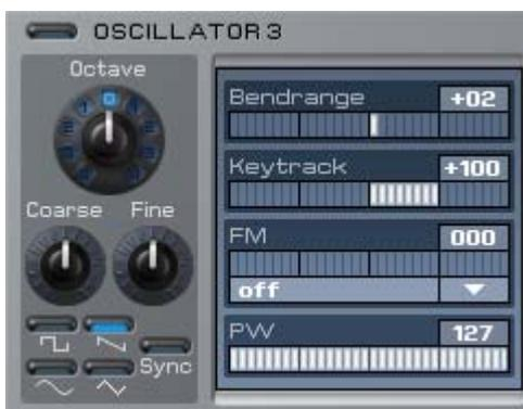
L'oscillatore 3 non dispone di forme d'onda di wavetable, ma può però essere sincronizzato con l'oscillatore 2. La larghezza dell'impulso della forma d'onda d'impulsi può essere impostata sotto PW e modulata nella matrice di modulazione sulla MATRIX Page. Se è stato attivato Sync, l'oscillatore 3 viene sincronizzato con l'oscillatore 2. Per ottenere dei tipici suoni Sync, provare un po' a sperimentare con gli involucri o con gli LFO
