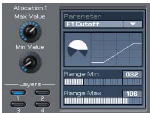
Per ogni parametro si può adesso stabilire in quale zona di rotazione esso debba essere influenzato dal MACRO-Controller e con quale intensità. Max- e Min-Value determinano in questo caso il valore minimo e quello massimo che può assumere il parametro. Possono essere anche generate direzioni negative. Range Min e Range Max stabiliscono in quale zona di rotazione venga cambiato il parametro. Con LAYERS viene scelto
