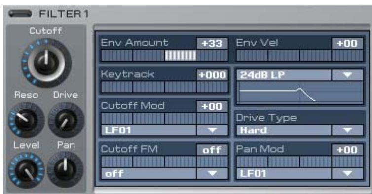
I filtri 1+2 sono a struttura identica e se non vengono utilizzati, essi possono essere disattivati tramite il pulsante posto accanto al testo per risparmiare potenza di calcolo. I filtri dispongono di funzioni particolarmente complesse e di oltre dieci
