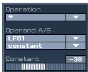
Una cosa molto particolare è la sezione ARITHMETIC. Essa permette di combinare due operandi attraverso funzioni logiche. I risultati sono disponibili quali sorgenti di modulazione. Un semplice esempio è l'inversione della forma d'onda di un LFO. A tale scopo si moltiplica l'LFO con un valore negativo costante. Nella matrice di modulazione si potrà poi scegliere quale sorgente la forma d'onda invertita al punto "Arithmetic 1".
