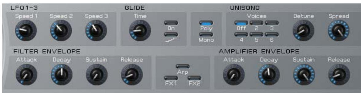
**LFO 1-3** - regolano la velocità degli LFO (Low Frequency Oscillator), gli stessi parametri sono anche presenti sulla ENV/LFO Page.
