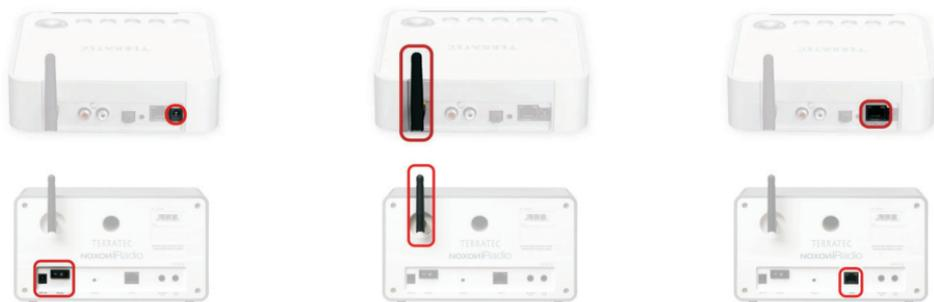
... brancher le bloc d'alimentation, l'antenne et le cas échéant le câble réseau (si vous avez un réseau filaire) ...
