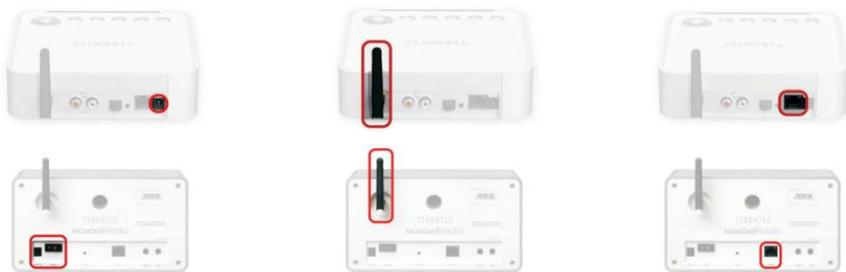
...conectar la unidad de alimentación, la antena y, en su caso, el cable de red (si no dispone de una red inalámbrica)...
