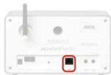
Qui viene stabilita la connessione attraverso un cavo di rete con un router, con uno switch o HUB, oppure direttamente con il PC attraverso un cavo crossover (con le linee dei dati "incrociate").
