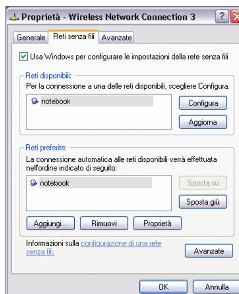
Alcune schede di rete WLAN non usano queste impostazioni immediatamente. Per essere sicuri che tutte le impostazioni effettuate per la connessione di rete vengano sfruttate, disattivare ed attivare ancora una volta la “Reti senza fili” scelta.
