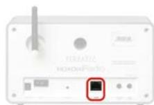
Ici la liaison est établie au moyen d'un câble réseau avec un routeur, un commutateur ou un concentrateur – ou directement avec votre ordinateur au moyen d'un câble crossover (avec câbles de données « croisés »).
