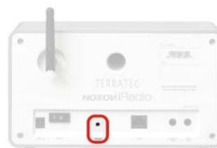
Para restablecer el aparato al **estado de entrega**, en el que se perderán para siempre todas las configuraciones, por ejemplo la clave de red, pulse con el aparato encendido el botón de reinicio durante aprox. 10 segundos hasta que el LED de Ethernet parpadee una vez. El display se apagará. Extraiga la unidad de alimentación del enchufe. Si conecta el iRadio de nuevo, pasados unos segundos, se comporta como la primera vez. Ahora se debe llevar a cabo de nuevo el proceso de instalación.
