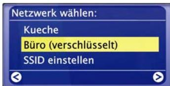
Hier werden die Namen der auffindbaren Access Points (Router) und der vorhandenen Ad-hoc Netze angezeigt.
