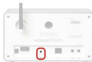
Um das Gerät in den **Auslieferungszustand** zurückzusetzen – wobei alle Einstellungen, zum Beispiel Netzwerkschlüssel, unwiederbringlich verloren gehen – drücken Sie im eingeschalteten Zustand den Reset-Taster für ca. 10 Sekunden bis die Ethernet-LED einmal blinkt. Das Display erlischt dabei. Ziehen Sie nun das Netzteil aus der Dose. Schließen Sie das iRadio nach ein paar Sekunden wieder an, verhält es sich wie beim ersten Mal. Der Installationsvorgang muss nun erneut durchgeführt werden.
