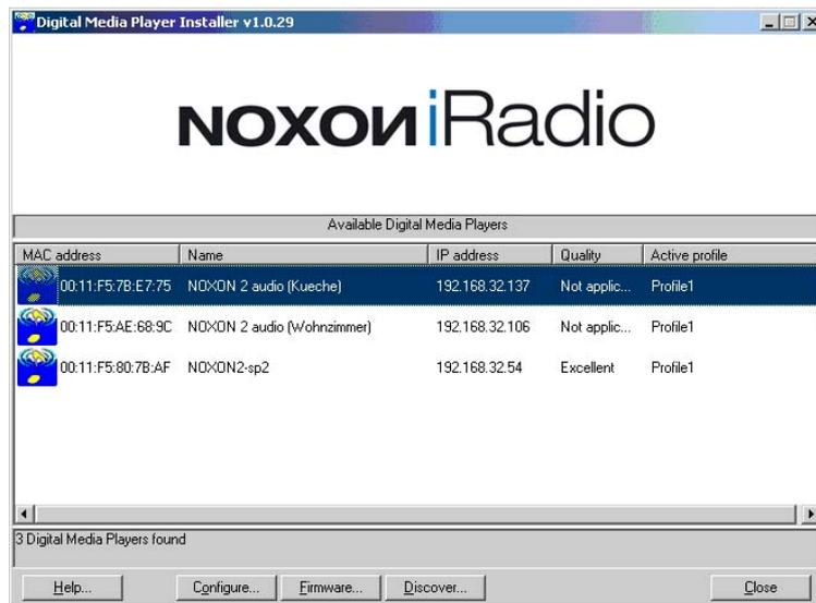
Nach Start und dem Durchforsten Ihres Netzes nach kompatiblen Geräten erhalten Sie eine ähnliche Ansicht wie oben abgebildet – dort werden alle Geräte mit MAC Adresse (der Geräteerkennung), dem Namen (Standard „NOXON iRadio“), der aktuellen IP-Adresse, der Verbindungsqualität zum Funknetz, und dem aktuell gewählten Profil angezeigt.
