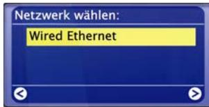
1) Ist die Kabelverbindung vorhanden, dann ist ‚Wired Ethernet‘ (engl.: Kabel-Netzwerk) die richtige Wahl! (Es erscheinen u.U. hier auch Funknetzwerke, wenn die Antenne dafür angebracht ist).
