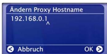
**5)** ... und geben den Namen („proxy\_internet“) oder die IP-Adresse ein. Die für die Eingabe notwendigen Tasten: Nummertasten 1-9, 1 für die Punkte, Links/Rechts für das Bewegen des Cursors, und die „Skip-Zurück“-Taste für das Löschen eines versehentlich eingegebenen Zeichens! (s. Kapitel 3.1)
