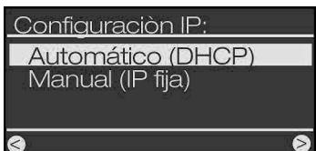
**3)** Adquisición de la dirección IP (prácticamente el "número de edificio" en la red): si no está seguro, seleccione simplemente "Automático (DHCP)". Para la mayoría de usuarios esta es la configuración correcta porque el router asigna la dirección IP automáticamente. Si quiere asignar la dirección IP usted mismo (dirección IP fija), seleccione la entrada correspondiente. Encontrará más información en el manual!
