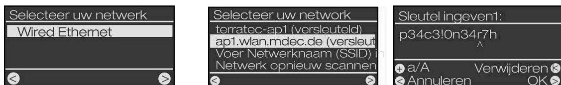
**A)** Wanneer u de NOXON via een kabel heeft aangesloten (Wired Ethernet), is de instelling zeer eenvoudig, omdat u geen netwerktoegangscode nodig heeft. Bevestig de keuze altijd met ►.
