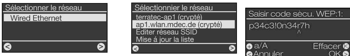
**A)** Si vous avez raccordé le NOXON avec un câble (Wired Ethernet), la configuration est très simple puisque vous n'avez pas besoin d'entrer une clé réseau. Confirmez la sélection de nouveau en appuyant sur ►.
