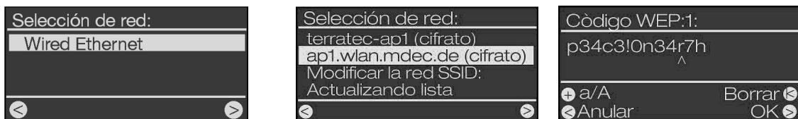
A) Se tiver conectado o NOXON por cabo (Wired Ethernet), a instalação é muito simples, visto que não necessita de uma chave de rede. Confirme novamente a sua selecção com ►.
