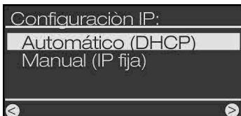
3) Aquisição do endereço IP (corresponde quase ao "número da porta de casa" na rede): se não tiver a certeza, seleccione simplesmente "Automático (DHCP)". Para a maioria dos utilizadores, esta é a configuração correcta, pois o próprio router atribui o endereço IP. Se pretender atribuir manualmente o endereço IP do aparelho (endereço IP estático), seleccione a entrada correspondente. Pode obter mais informações no manual!
