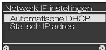
**3)** Toekennen IP-adres (net zoets als het "huisnummer" in het netwerk): wanneer u niet zeker bent, kiest u eenvoudig 'Automatisch (DHCP)'. Voor de meeste gebruikers is dat de juiste instelling, omdat de router het IP-adres zelf toekent. Wanneer u het IP-adres van het apparaat zelf wilt toekennen (statisch IP-adres) kiest u de betreffende positie. Meer informatie vindt u in het handboek!
