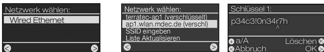
**A)** Wenn Sie den NOXON über Kabel angeschlossen haben (Wired Ethernet), ist die Einrichtung sehr einfach, da Sie keinen Netzwerkschlüssel benötigen. Bestätigen Sie die Auswahl abermals mit ►
