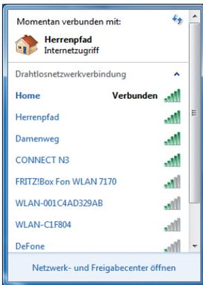
Klicken Sie doppelt auf den N3 Eintrag. Windows wird jetzt versuchen eine Verbindung herzustellen. Da der N3 mit WPA2 verschlüsselt ist, erscheint als nächstes eine Abfrage des WLAN-Schlüssels. Geben Sie hier den WPA2 Key, welchen Sie auf der Unterseite des N3 finden, ein.
