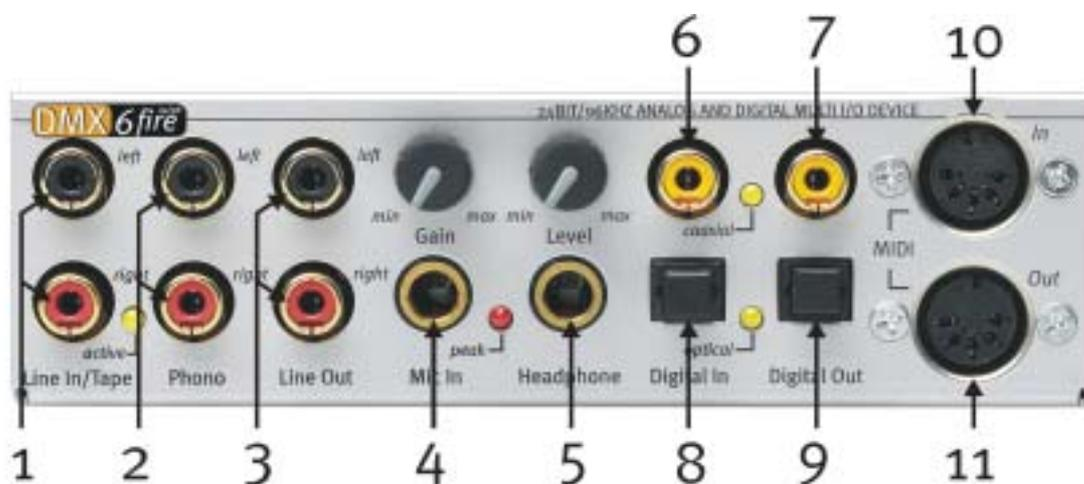
1. Ingresso audio stereo (cinch, con LED di segnale) per apparecchi con ingresso Line, ad esempio piastra a cassette
