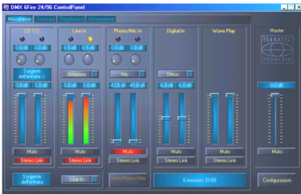
*Nella pagina Miscelatore regolate le sensibilità e i volumi, attivate l'equalizzazione Phono e scegliete una sorgente di registrazione.\* La parte destra del DMX ControlPanel rimane sempre invariata e pilota il volume complessivo del sistema.*
