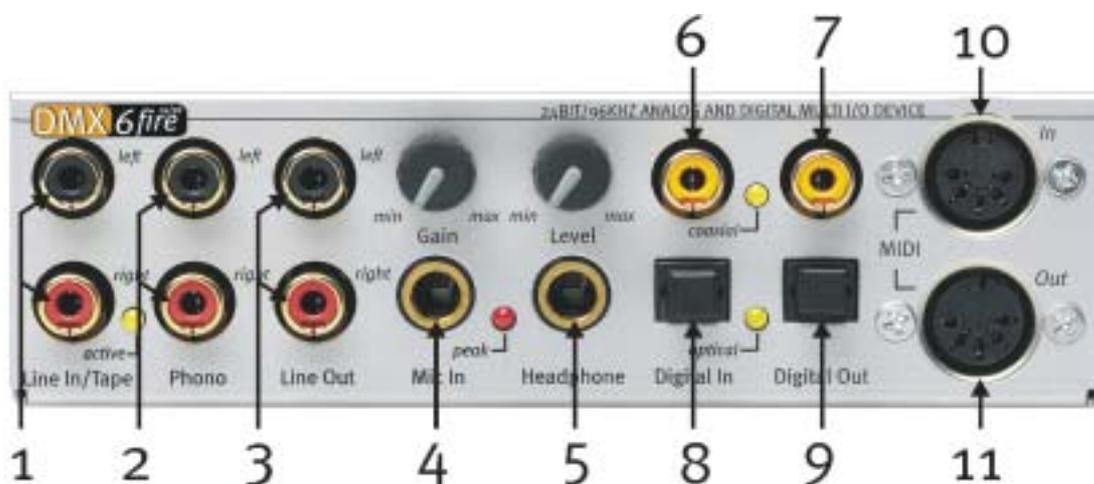
1. Stereo Audio-Eingang (Cinch, mit Signal-LED) für Line-Geräte, z.B. Kassettendeck
