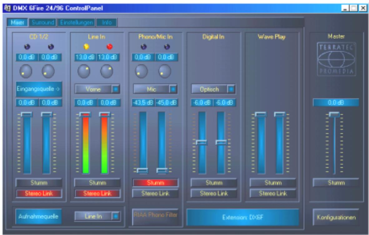
*Auf der Mixer-Seite regeln Sie Empfindlichkeiten und Lautstärken, schalten die Phono-Entzerrung<sup>1</sup> und wählen eine Aufnahme-Quelle. Der Rechte Teil des DMX-ControlPanels bleibt immer gleich und steuert die Gesamtlautstärke des Systems.*
