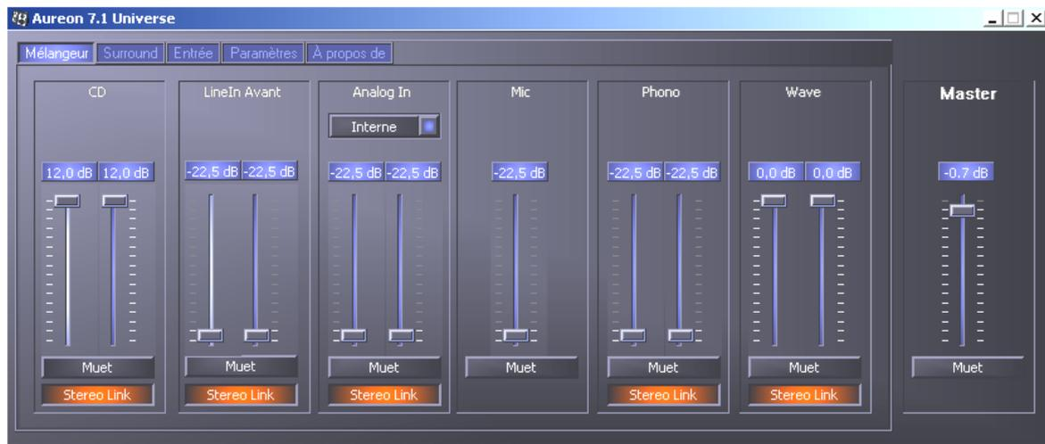
*Du côté mélangeur, vous réglez le volume de toutes les sources. La partie droite du panneau de configuration Aureon reste toujours pareil et sert à régler le volume général du système.*
