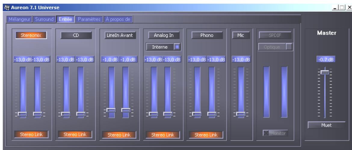
Les boutons au-dessus des réglettes permettent d'indiquer laquelle des entrées est utilisée pour un enregistrement. Si vous ne pouvez pas vous décider pour une seule entrée, vous disposez de la fonction « Stereomix » : elle permet de mélanger les signaux de toutes les entrées pour n'avoir plus qu'un seul signal.
