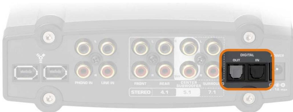
Esta entrada situada en la parte trasera del módulo (“DIGITAL IN”) permite conectar mediante un cable óptico (también denominado guía de ondas o conector TOS) por ejemplo la salida de un amplificador digital, para registrar la reproducción de los aparatos conectados con su Mac / PC mediante el software correspondiente (p. ej. Wavelab). Por supuesto, también puede conectar la salida óptica de una grabadora de MiniDisc con esta entrada para conservar en el disco duro viejos tesoros en MiniDisc.
