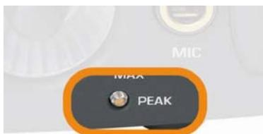
Por debajo del regulador se encuentra un diodo luminoso con el rótulo PEAK que indica si existe el riesgo de sobreexcitación de la grabación. Si el diodo solo brilla tenuemente de forma intermitente, la grabación es correcta; si se ilumina claramente, es recomendable corregir el nivel hacia abajo.
