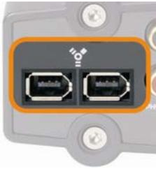
Verbinden Sie das FireWire-Kabel auf der einen Seite mit dem FireWire Anschluss Ihres PCs oder Laptops und mit der als
