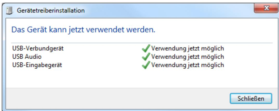
Nach der Installation überprüfen Sie bitte im Geräte-Manager die korrekte Einbindung der Soundkarte. Hier wird die Aureon 5.1 USB MKII als „USB Audio“ angezeigt.
