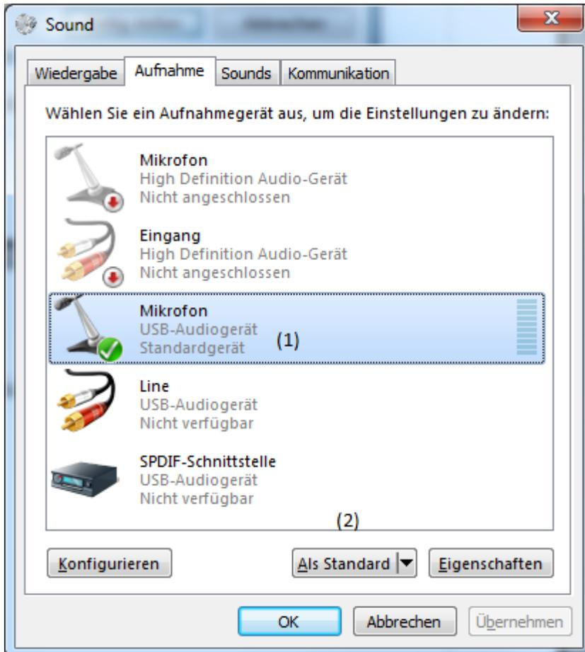
Hier wird das Gerät ebenfalls als USB-Audiogerät (1) angezeigt. Wie schon in der Konfiguration zur Wiedergabe, klicken Sie bitte auf das USB-Audiogerät (1) und legen dies als Standard (2) fest. Die Einstellung hier gilt für die Aufnahme über Mikrofon. Sollten Sie den „Line-Eingang“ für die Aufnahme verwenden möchten, so wählen Sie hier bitte den „Line“ Eingang des USB-Audiogerätes aus und deklarieren Sie diesen dann als Standardgerät (2).
