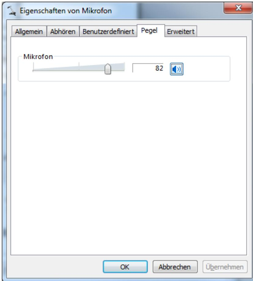
Hier stellen Sie dann unter „Pegel“ noch die Mikrofonlautstärke ein. Anschließend übernehmen Sie die Einstellungen noch. Jetzt können Sie alle Fenster schließen, die Konfiguration ist jetzt vollständig abgeschlossen und die Aureon 5.1 USB MKII als Aufnahme- und Wiedergabegerät unter Windows 7 nutzbar.
