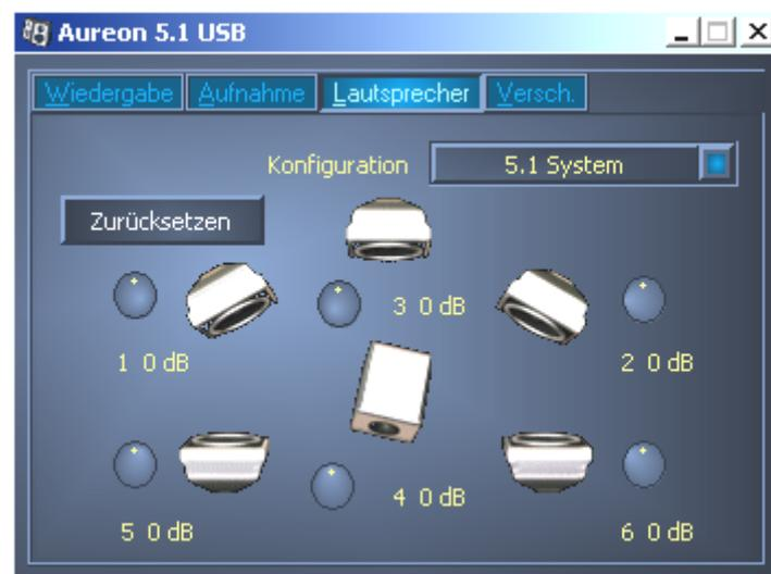
Unter jedem Lautsprecher ist eine Anzeige, die erste Zahl (1-6) gibt an, an welchem Ausgang der Aureon 5.1 USB dieser Lautsprecher angeschlossen werden muss. Die andere Anzeige (+/- 20 dB) steht im Zusammenhang mit den Drehreglern, in der Nähe der Lautsprecher.
