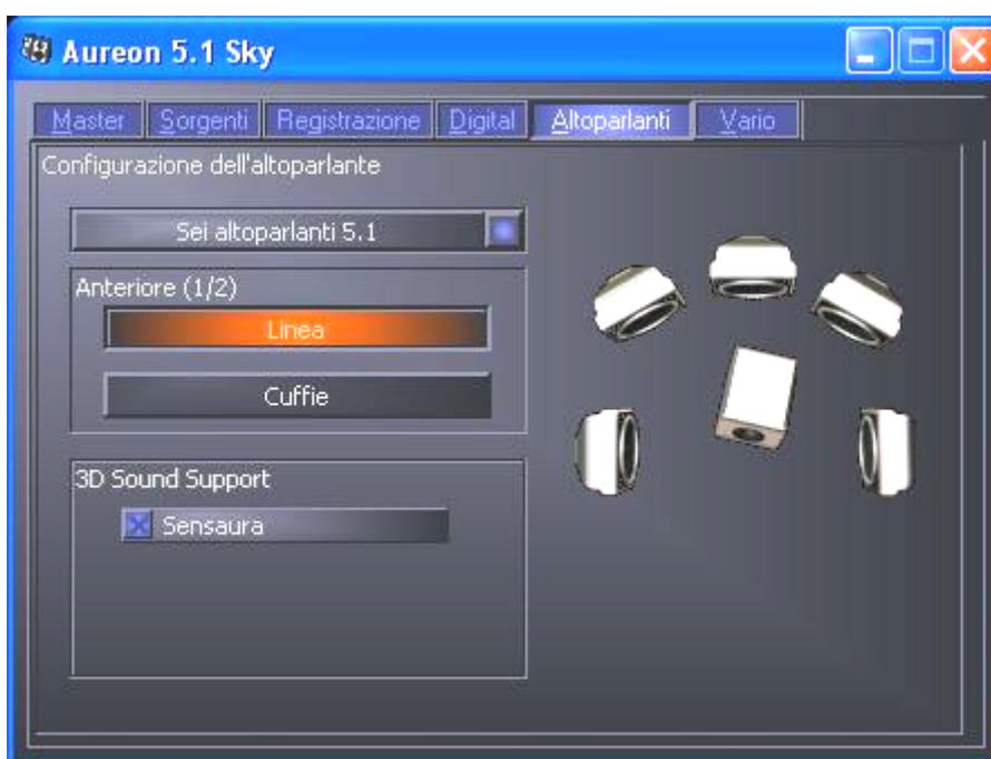
Particolarmente importante è la giusta configurazione di altoparlanti. Solo in tal modo viene assicurato che l'algoritmo 3D usato offra ottimali risultati. La configurazione degli altoparlanti scelta può essere testata subito. Se si clicca su un altoparlante sulla destra, su tale canale viene emesso un tono di prova continuo e il corrispondente simbolo dell'altoparlante cambia colore. Un nuovo clic disattiva il tono di prova.
