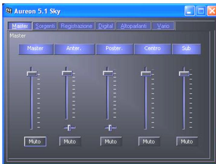
*La posizione nel campo stereo si regola tramite i cursori Panorama posti sotto ai potenziometri del volume.*
