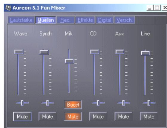
Alle Signalquellen können mit einem Druck auf die MUTE-Taste stumm geschaltet werden. Diese werden jedoch trotzdem mit aufgezeichnet, wenn Sie die Quelle explizit ausgewählt haben.
