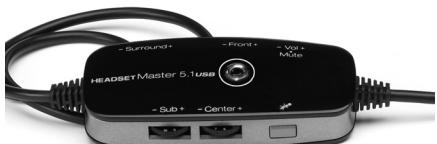
Accendere il PC e attendere che Windows sia stato completamente caricato. Collegate la cuffia con microfono Master 5.1 USB ad una presa USB libera. Il LED blu del controller si accende.
